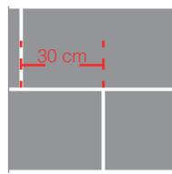
En cualquier forma de instalación, la distancia entre juntas cortas no puede ser menor a 30cm.
